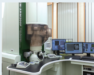
原子分解能分析電子顕微鏡 JEM-ARM200F
