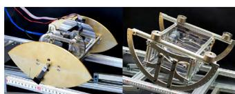
写真2. 撻動と揺動を利用した劣駆動移動ロボット
