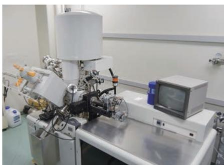
XPSは、試料の表面近傍に存在する元素の電子状態を精密に分析する手法です。金属、絶縁物、有機物等あらゆる元素を分析できます。さらに、分析対象となる原子周囲の電子状態によって起こる結合エネルギーの変化(化学シフト)を観測することで、化学結合状態を比較的容易に識別可能であることもXPSの特長と言えます。最小分析径は15  $\mu\text{m}\phi$ であり、また1 wt.%程度の元素濃度であれば測定可能になります。数回の講習(日本語/英語)を経て技術を習得すれば自分で測定評価できます。
