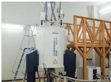
NMRでは、強磁場にさらされた原子核のスピンによる磁気共鳴スペクトルを測定します。共鳴周波数は磁場の強さと核種によってほぼ決まりますが、核のまわりの状況を反映した少しのずれ(化学シフト)から原子配置や電子構造などに関する情報が得られるため、有機化合物、高分子化合物、タンパク質などの構造解析にはなくてはならないものです。JAISTには、プロトンの共鳴周波数が800、500及び2台の400MHzの装置が揃っており、学生は500MHz以下の装置を使用できます。
