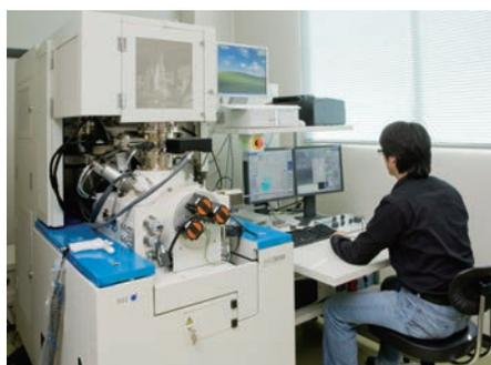
本装置では、集束イオンビームを照射した試料の表面から発生する二次電子を検出することにより、走査イオン顕微鏡 (SIM) 像と呼ばれる試料表面の画像を取得することができます。SIM像を観察しながら、試料の目標位置で微細加工を行うことが可能です。JAIST 所有の Ga イオンビームを用いた FIB 加工装置には、低加速 FIB による低ダメージ加工の機能があります。また、試料表面にタンガステンを蒸着するためのガス銃が付属しています。さらに、加工した微小な試料片を拾い上げる機構を有しています。JAISTでは本装置を用いて、透過電子顕微鏡の断面観察用の試料作製が行われています。
