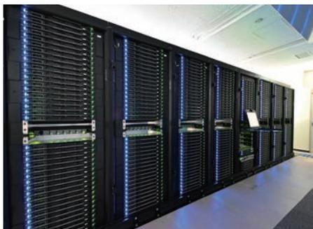
大規模並列計算機とは、多数の計算専用のノードを並列接続することにより構成される科学技術計算のための専用コンピュータシステムを指します。計算ノードは汎用高速ノードのほか、大規模メモリノードやGPUなど様々なアーキテクチャを有し、計算の用途に応じた使い分けが可能です。ナノテクノロジーからビッグデータ、機械学習など幅広い分野に活用され、一台のパソコンでは不可能な大規模、大量の実験を短時間で完了させることができます。
