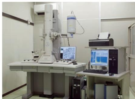
TEMとは、電子を高速に加速して試料薄片を透過させ、電子レンズを用いて拡大し結像させることで、物質の微細な構造を観察する装置です。加速された電子の波長は可視光の波長より非常に短いため、光学顕微鏡より高い分解能で観察することが可能です。JAISTには加速電圧が200kV及び100kVのものがあり、通常、学生が使用できる100kVのTEMは、分解能が0.2nm(格子像)、0.36nm(粒子像)です。微細な観察領域に含まれる元素を同定する装置も備っています。
