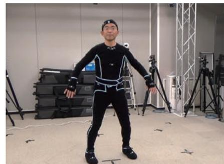
本装置は16台のカメラから成り、3次元空間内での人間の運動を正確に追跡できます。本装置は運動解析のほか、収集した動作データを使ってアニメーションのキャラクターを動かすといった目的でも使えます。さらにヘッドマウントディスプレイと組み合わせた場合、利用者の動きに合わせてVR空間を操作できるので、多人数がVR空間で共同作業するようなコンテンツを作成できます。脳活動と視線を同時計測可能なヘッドマウントディスプレイが1基ありますので、VR空間内での人の挙動を脳活動・視線・動作という三つの観点から同時計測できます。
