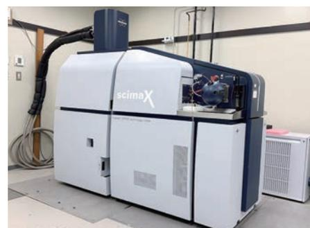
極めて高い検出感度と分解能を誇る、超伝導磁石を用いたフーリエ変換型質量分析計です。この装置を用いることで、ピコ〜フェモトルオーダーの分子でも精密質量分析が可能です。試料中に含まれる成分の分子組成を決定ことができ、未知試料の分析に力を発揮します。また、生体組織切片や材料中に含まれる目的分子の局在を可視化する、質量分析イメージングを行うこともできます。JAISTにはこの他、MALDI-TOF/TOF MS や GC-TOF MS など多様な質量分析装置が揃っています。研究内容に沿って低分子化合物から高分子材料、タンパク質などの生体分子まで、物性の異なる様々な試料に対応することができます。
