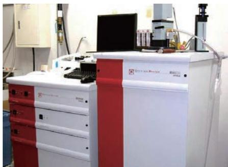
ジョセフソン接合を有する超伝導体リングから構成される超伝導量子干渉素子(SQUID)は、超伝導体の量子干渉効果により、リングを貫く磁束量子の増減を電流変化として検出できるものです。このSQUIDを磁束計として用いることで、本装置では地球磁場の1万分の1の微小な磁束変化を高精度に検出することができ、様々な試料の磁化(磁化率)について測定することができます。また、コンピュータ上で簡単な測定シーケンスを組めば、磁場や温度の制御、測定データ取得、ヘリウムガスの液化・充填を全自動で行うことができます。磁性薄膜や磁性ナノ粒子など新材料分析や、それらを利用したスピントロニクス素子の開発に活用されています。
