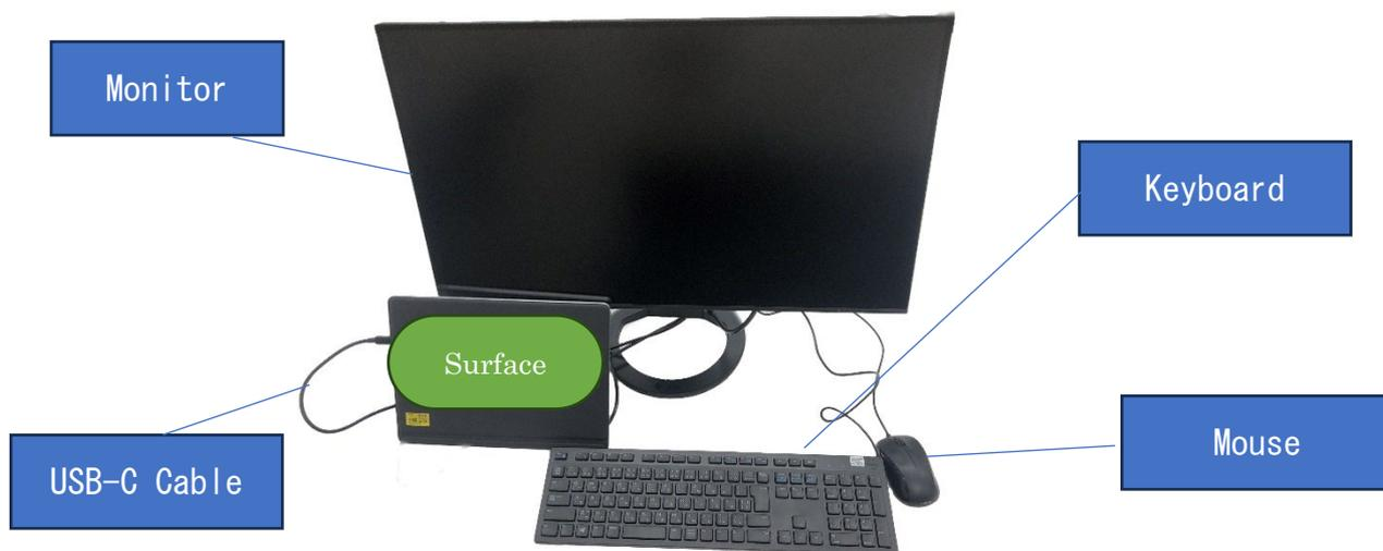
机上に SurfaceDock が設置されていない場合、同時設置機器は上記の 4 点になります。写真のように、USB-C ケーブルで Surface 本体とモニタを接続します。モニタに USB-A ポートがついており、USB ハブとして使用できます。
