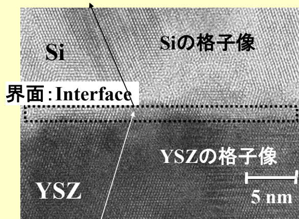
図2 YSZ界面から低温結晶化したSi薄膜の断面TEM像
